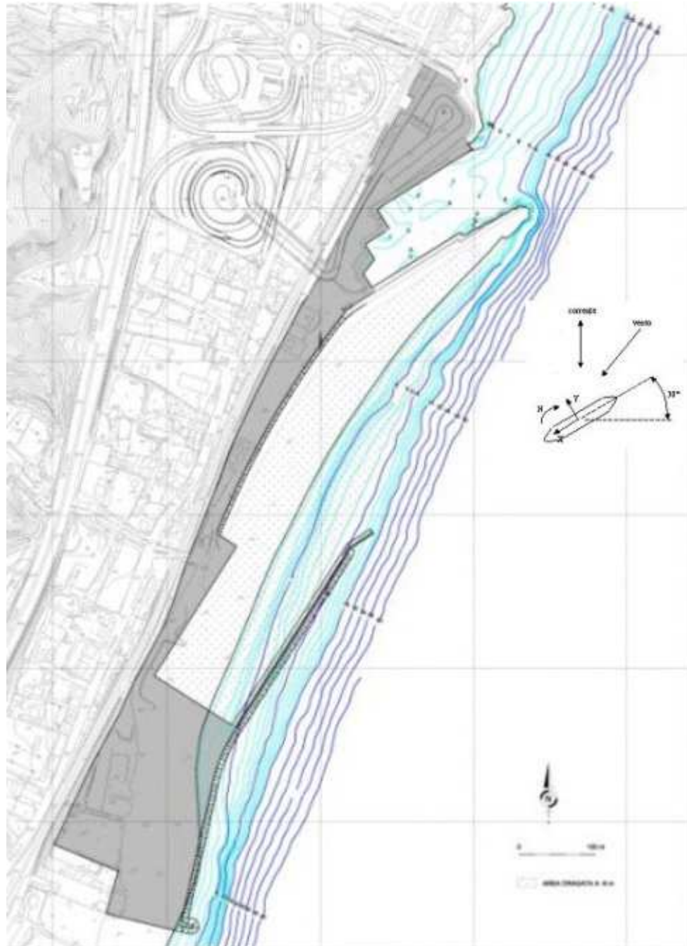
Figura 1E. Posizione della nave rispetto alla corrente e convenzioni sui segni assunte nei calcoli
