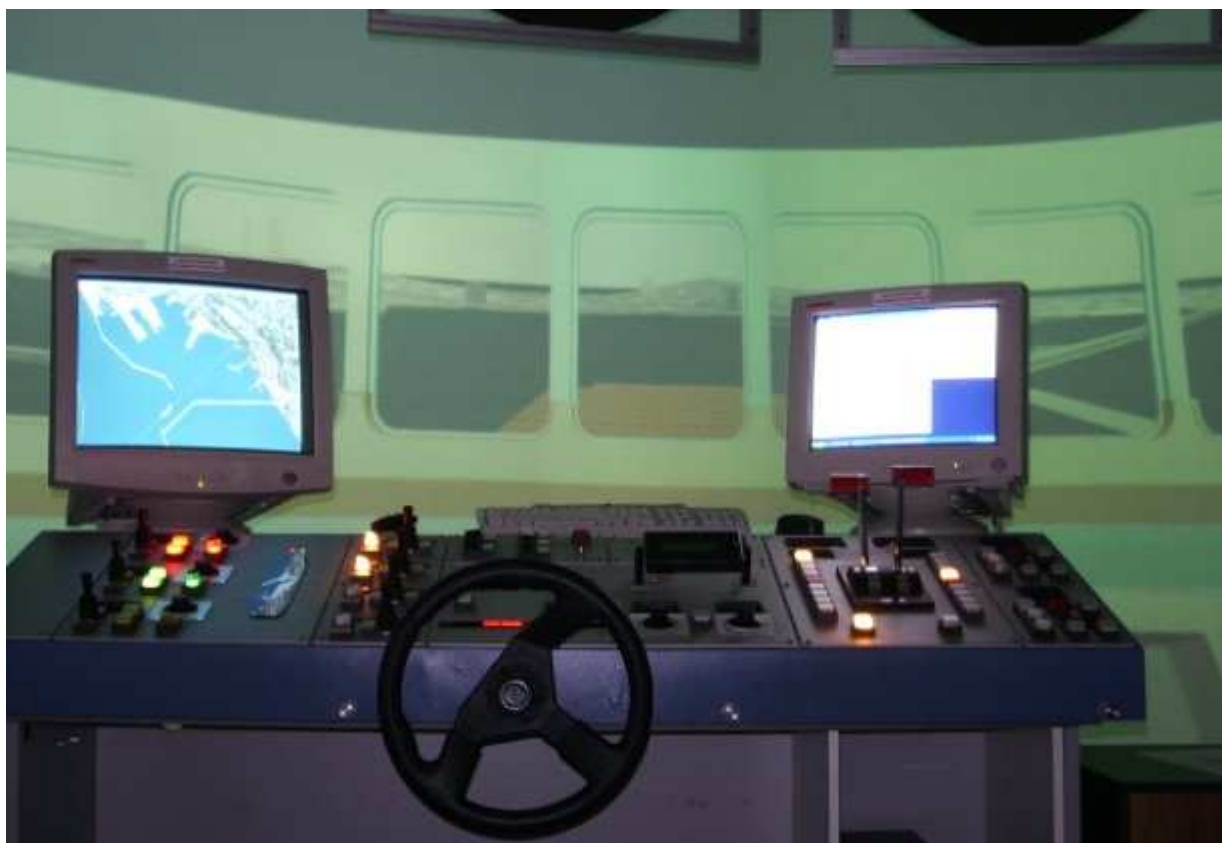
Figura 3 – Simulatore di manovra – Esempio di vista della plancia e dello schermo tridimensionale
