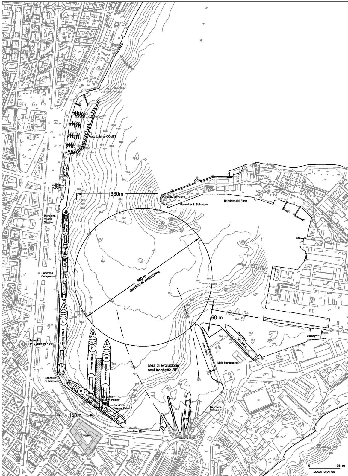
Fig. 5.10 Aspetti navigazionali, navi RoRo – Configurazione di PRP e/o con eventuale sporgente trasversale per navi da crociera
