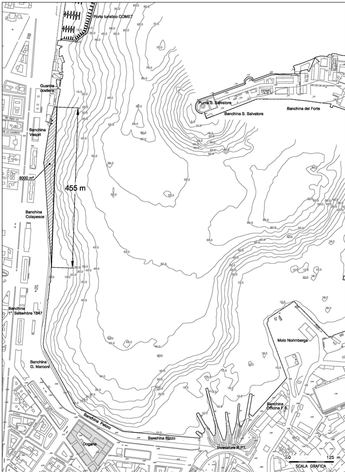
Fig. 4.1 Stato di fatto e progetto di allargamento banchina Vespri e Colapesce (adeguamento tecnico funzionale approvato, lavori in appalto)
