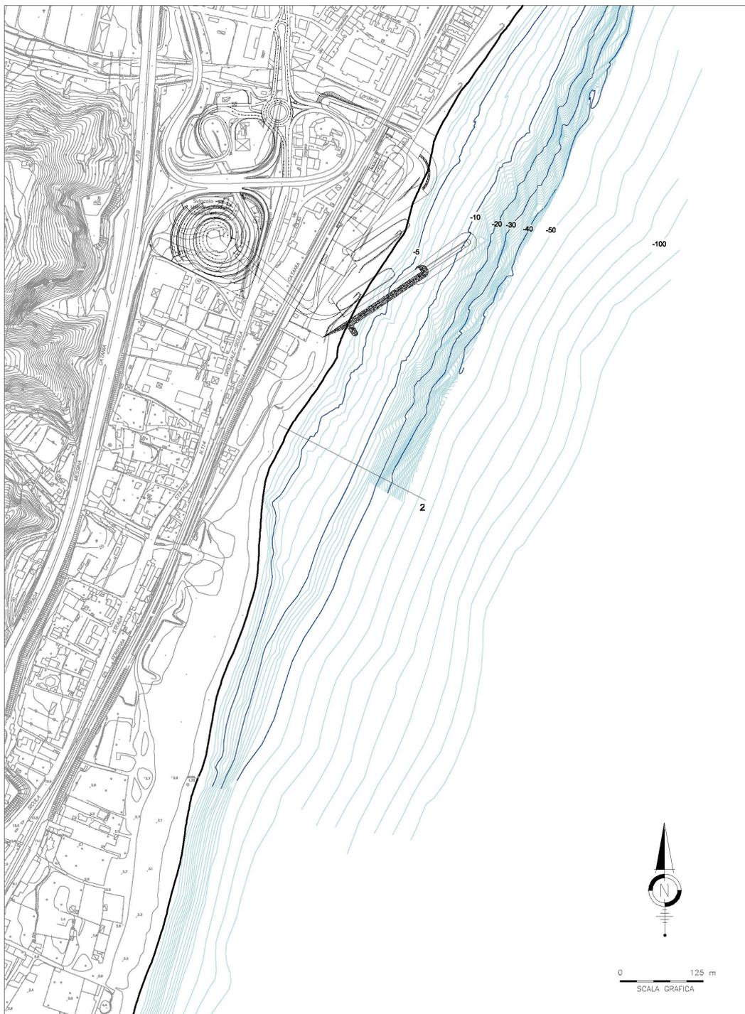
**Fig. 2.17 Tremestieri: ubicazione del profilo trasversale utilizzato per il calcolo del trasporto longitudinale**
