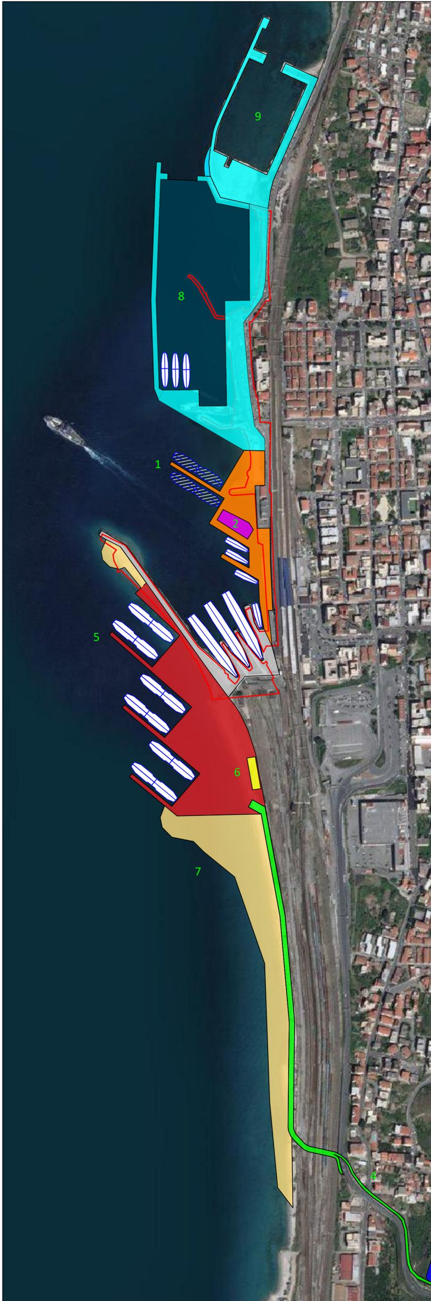
1. RISANAMENTO STRUTTURALE DELLA BANCHINA "SCIVOLO 0" E REALIZZAZIONE DI NUOVI BANCHINAMENTI (20.000mq) PER L'OTTIMIZZAZIONE DEGLI ATTRACCHI DEI MEZZI VELOCI (FASE 1) E L'IMPLEMENTAZIONE DEI SERVIZI AI PASSEGGERI (FASE 2)
